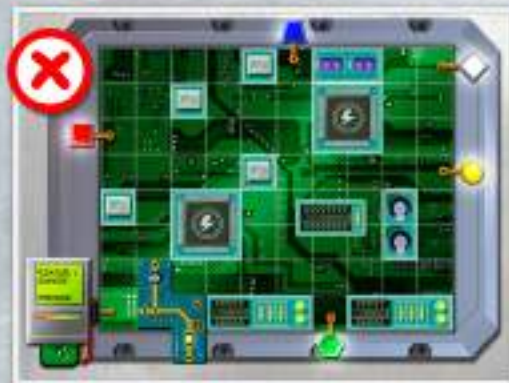
Emplacement incorrect (chevauchement avec un composant ou à l'extérieur de la zone du circuit imprimé)
