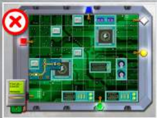
Emplacement incorrect (chevauchement avec un composant ou à l'extérieur de la zone du circuit imprimé)
